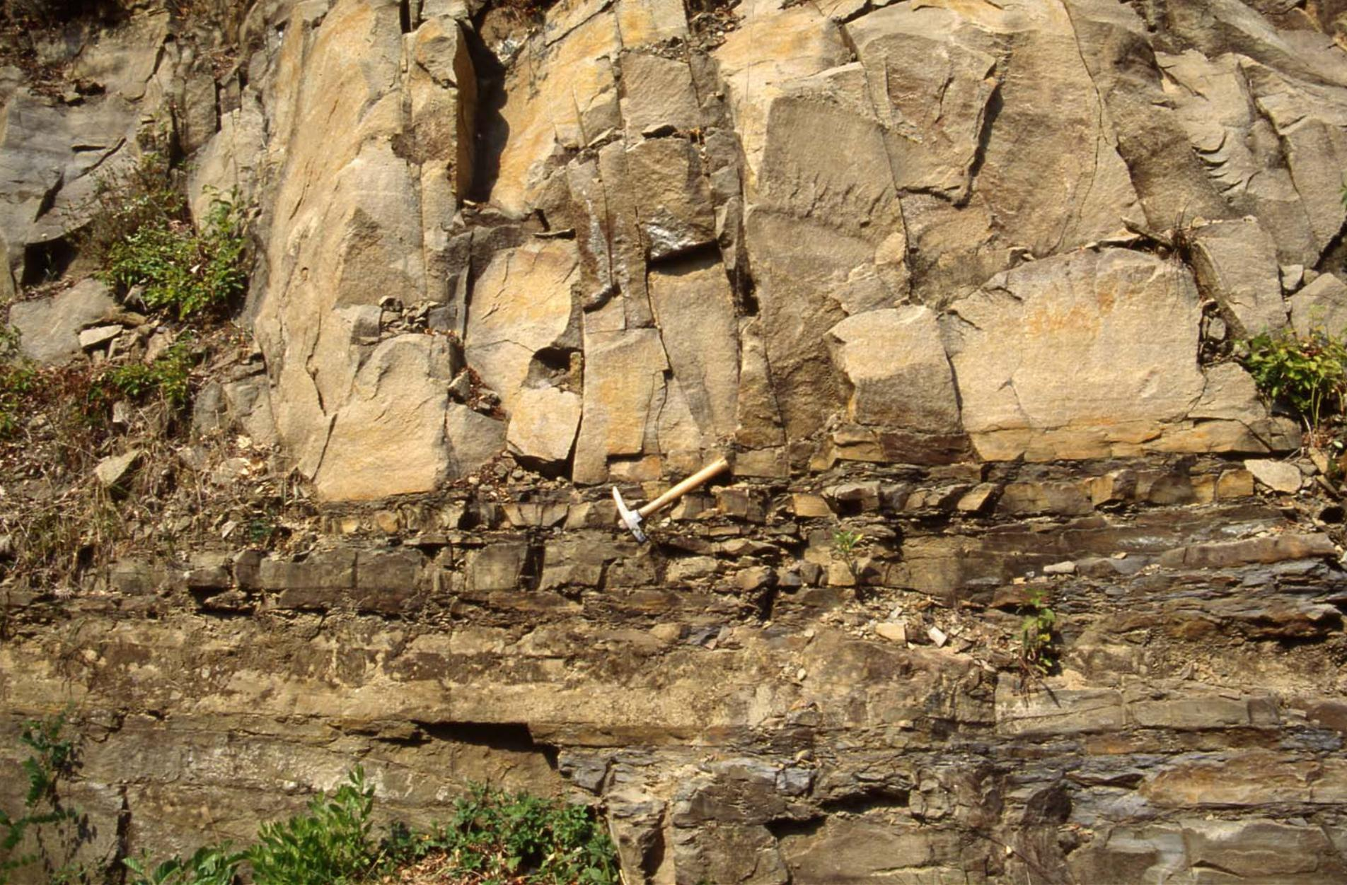
**Arenarie torbiditiche molto coerenti: la buona cementazione conferisce un elevato stato di aggregazione (Macigno di Pontremoli)**
